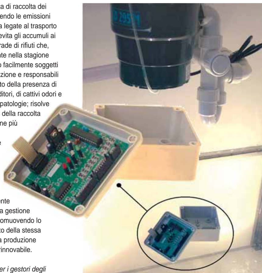
Figura 4 - Dissipatore di rifiuti alimentari (DRA) e sistema SiQURO.
