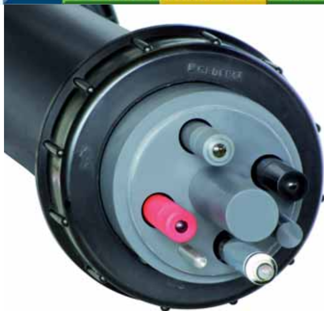
Ise Max Cam40 portasensore a immersione con elettrodi a ioni selettivi di ammonio, nitrati e elettrodi di compensazione.
