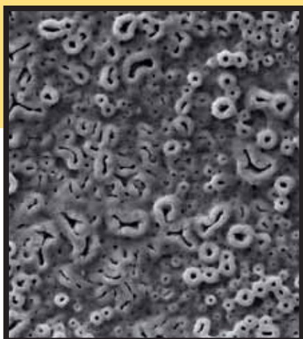
Pag 15 Fotocatalisi con \text{TiO}_2 su titanio
