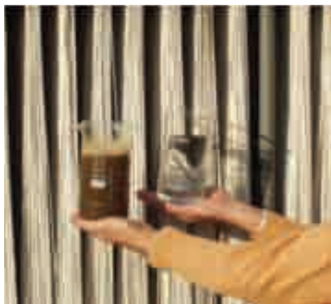
Figura 1 - Miscela aerata e acque filtrate in un processo Mbr.
