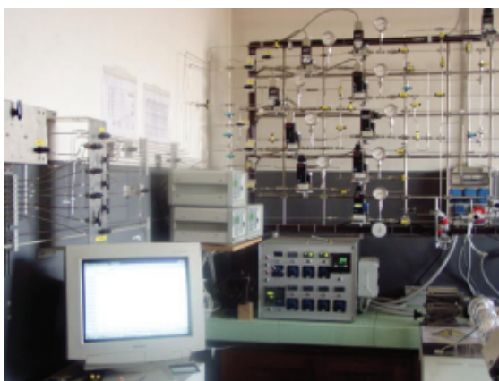
Linea di attività catalitica per la prova di catalizzatori.
