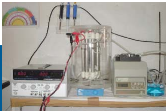
Figura 2 - Foto del sistema utilizzato per l'attivazione elettrochimica costituito da un alimentatore, dagli otto Fem collegati in parallelo e da una pompa peristaltica.
