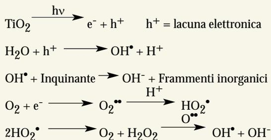
Allora aggiungendo alla composizione dell'asfalto o a quella dell'intonaco per pareti interne una certa quantità di biossido di titanio e sfruttando la luce solare, o di lampade che la simulano, si potrebbe supporre di fotodegradare cataliticamente alcuni comuni inquinanti dispersi nell'ambiente. In effetti le cose non stanno esattamente così per differenti motivi.
