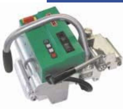
**È** presentato da **Muzi Mohwinkel** l'apparecchio automatico denominato Astro destinato alla saldatura a cuneo caldo ad elevata velocità garantita. L'apparecchio permette di saldare manti di impermeabilizzazione di scavi e bacini, con spessori da 1,5 fino a 3 mm in HD-PE. Facile da manovrare e semplice nella funzionalità: con una leva vengono inserite contemporaneamente la pressione sul giunto da saldare e l'inserimento del cuneo nella
