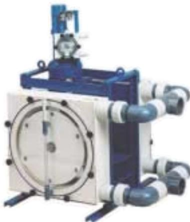
alberi di rotazione in acciaio inox, da coperchio in plexiglas e da guarnizioni in Viton. La pompa è quindi ideale per il travaso di liquidi anche notevolmente viscosi e corrosivi; può funzionare in entrambi i sensi di rotazione, non soffre il funzionamento a secco e lavora fino a 120 °C di temperatura.
