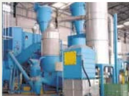
presentato il densificatore modello 2003, dotato di banco strumentazioni separato, che evita le vibrazioni ed il surriscaldamento dei propri componenti, e di sistema di gestione con PLC, completamente automatico, che permette di lavorare senza la presenza dell'operatore.
